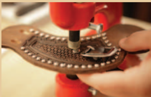
Mit Hilfe einer Spindelpresse werden Nieten angebracht. ...
